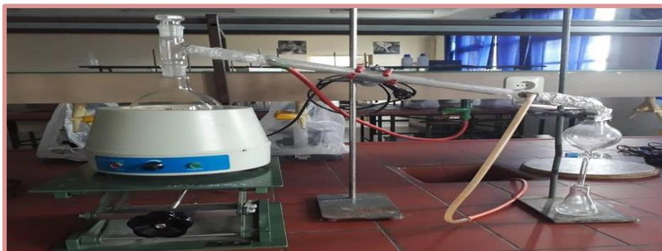
**Figure 10** : Appareil d'hydro distillation type Clevenger
