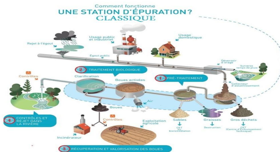
Figure 08: Schéma D'une station d'épuration classique. (Racault,1996)
