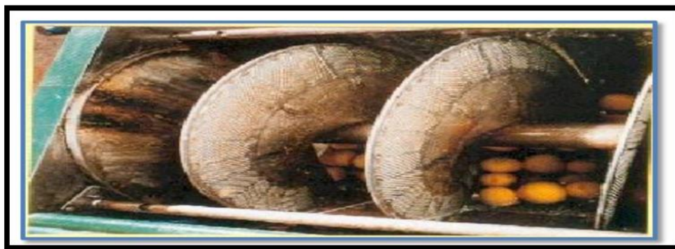
Figure 23 : Presse hydraulique pour la méthode d'expression à froid (Guerrouf, 2017).
