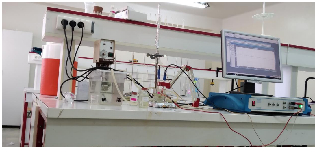
Figure 10 : Dispositif des mesures électrochimiques (Voltalab PGZ 301).
