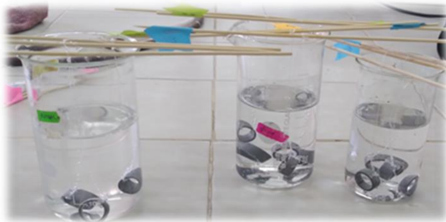
Figure 1 : Immersion de l'acier dans la solution HCl 1M.
