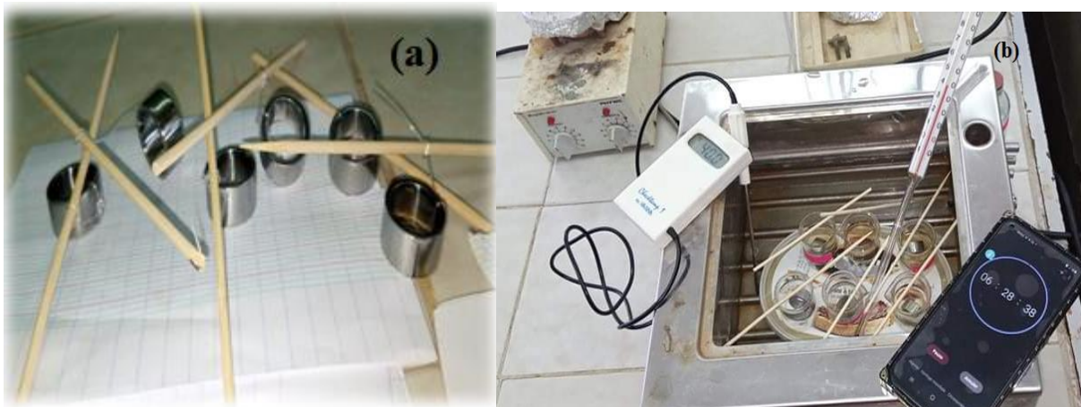
Figure 4 : Image montrant les appareils utilisés dans la technique gravimétrique : a) les anneaux en acier polis et attachés à des fils de pêche, b) les échantillons d'acier dans un bain marie.
