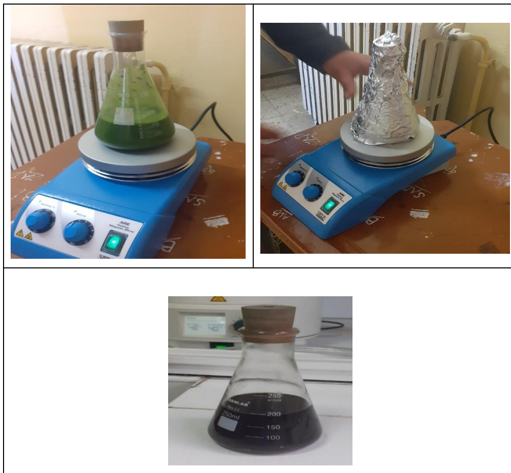
Figure 9: Protocole expérimental de la méthode d'extraction solide/liquide (photo personnel, 2022)
