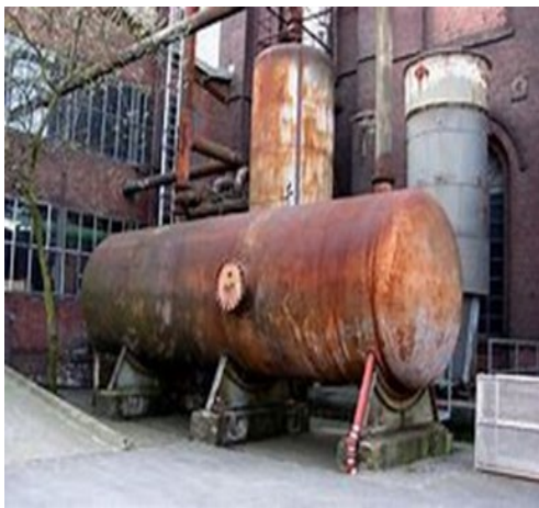
Figure- I.1. Corrosion uniforme (exemple d'un réservoir et d'un véhicule corrodés)
