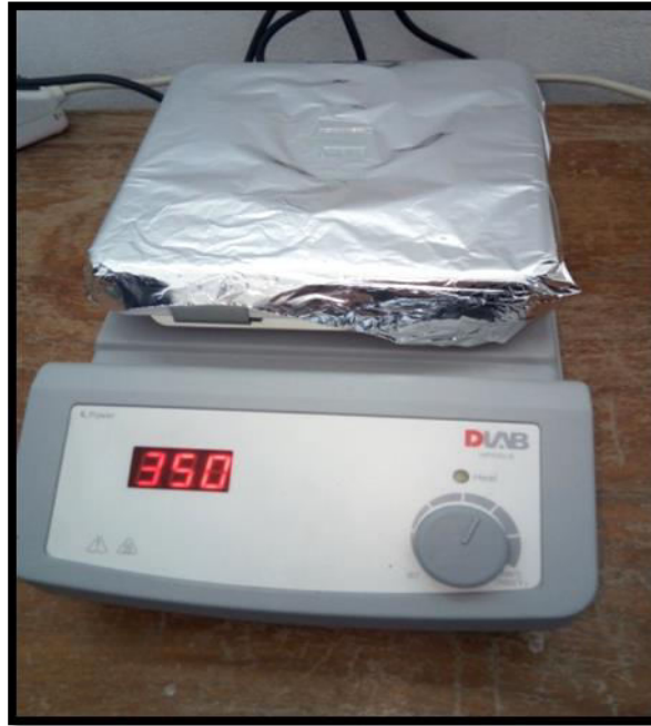
Figure II.7 : Le substrat à la porte du substrat chauffant.
