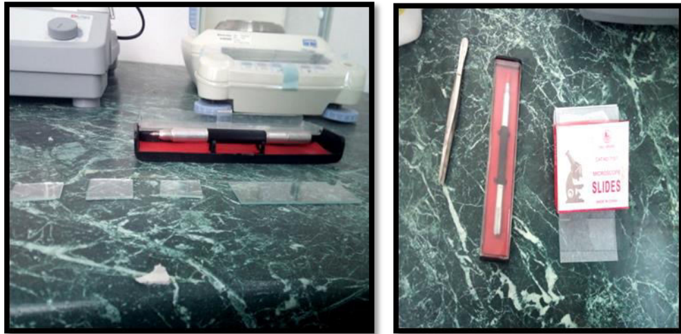
Figure II.4 : Stylo diamanté, substrat de verre et pincette.
