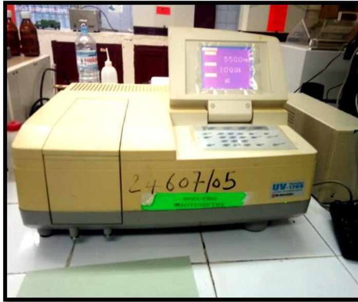
Figure II.13 : Spectrophotomètre UV-Visible (UV-PC 1700).
