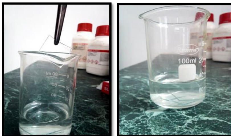
Figure II.5 : Nettoyer le substrat avec du méthanol .
