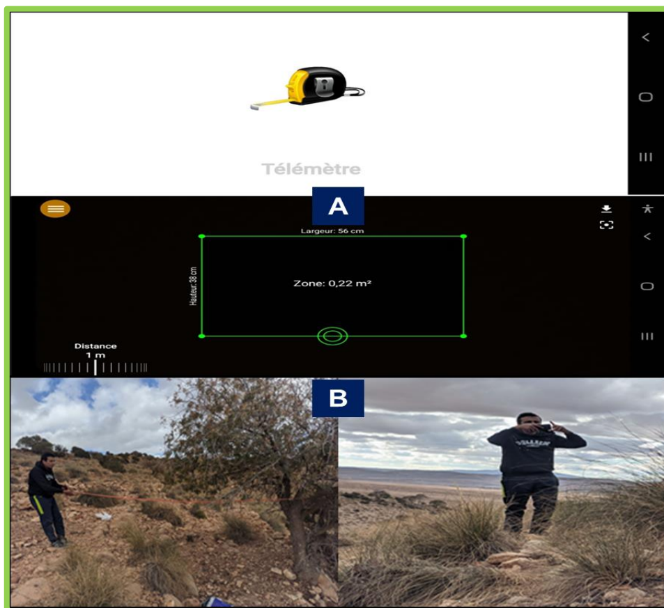
Figure 20. A : L'interface de l'application de télémètre électronique version 2.8.0 ; B : La prise des différentes mesures de l'arbre en utilisant le télémètre électronique version 2.8.0 (Cliché Aloui, 2022).
