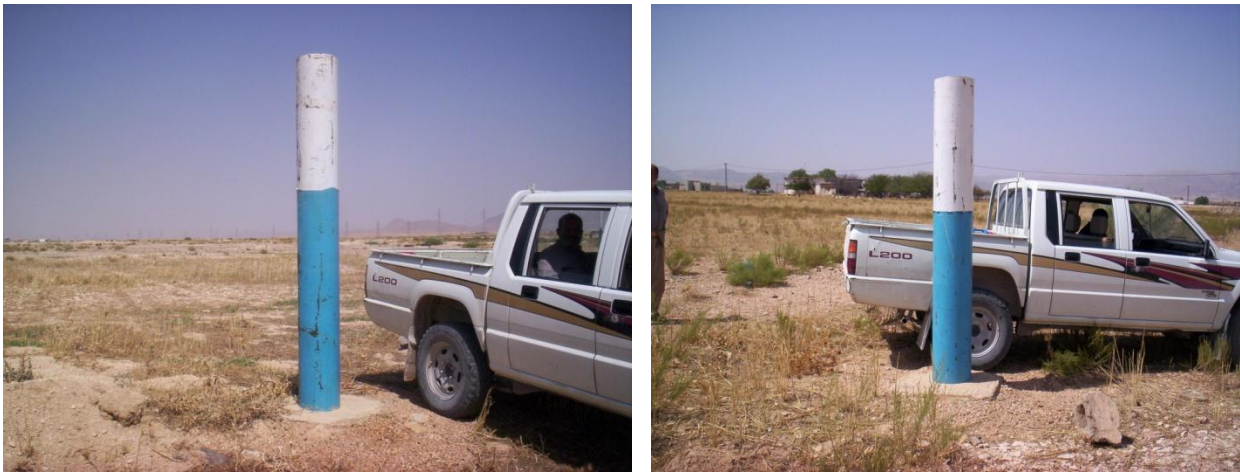
Figure IV.19 : piézomètres utilisés dans la région Gueriger
