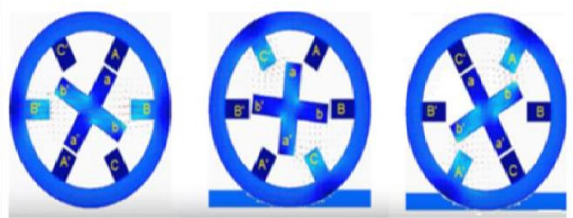
Fig.II.7.Structures des MRV pour différentes combinaisons des nombres de dents et de phases [19]
