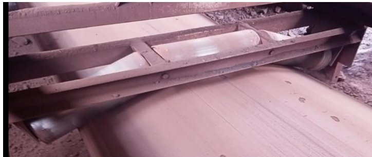
Figure IV.19 : Rouleaux guide [prise de la photo]
