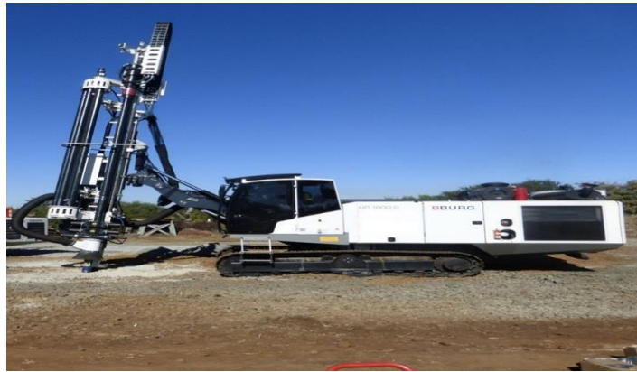
Figure IV.5 : Représente d'une sondeuse de type B. Burg HD 1500 D.
