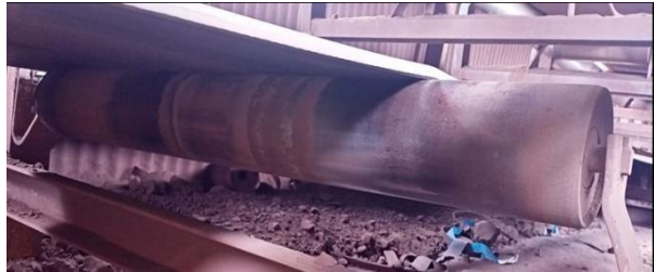
Figure IV.17 : Rouleaux inférieurs [prise de la photo]
