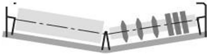
Figure .III.13.2 rouleaux ordinaires ou amortisseurs de bagues caoutchouc [29]
