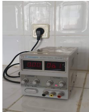
Figure IV.48 Alimentation stabilisée et régulée.
