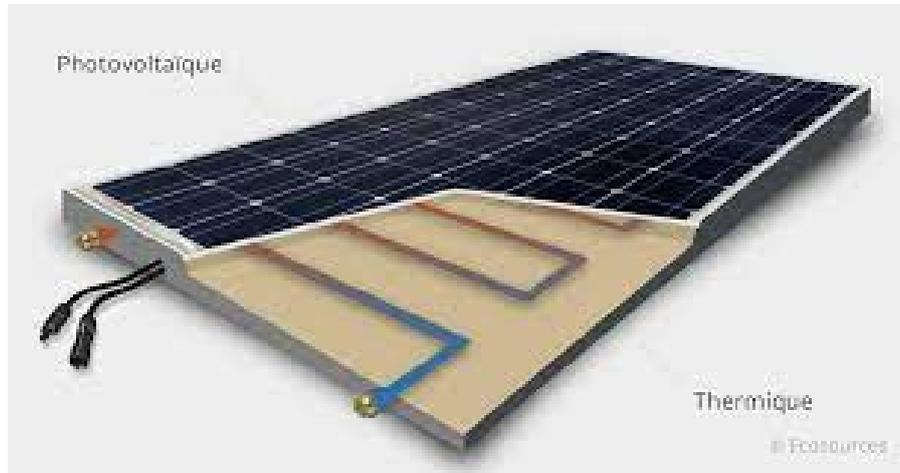
**Figure III . 9** Le panneau solaire aérovoltaïque (hybrides)
