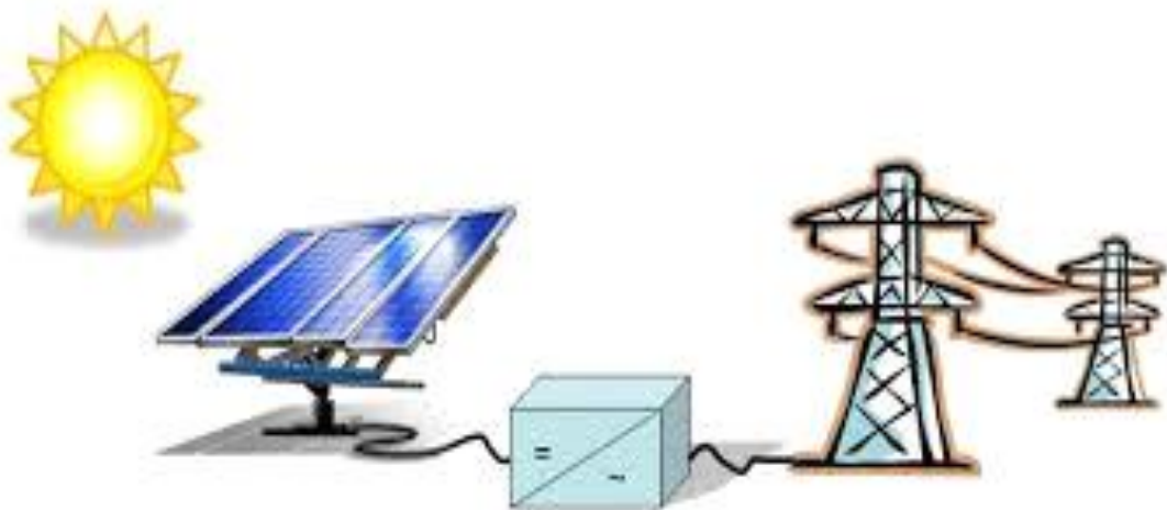
Figure 4.1 : Constituants d'une chaîne photovoltaïque
