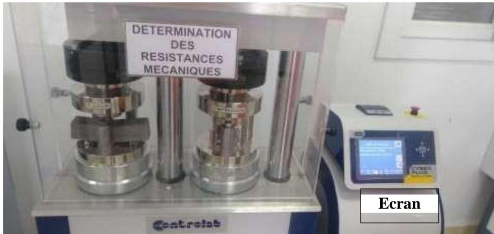
Figure III.16 : Appareil de mesure de la rupture à la compression et à la flexion
