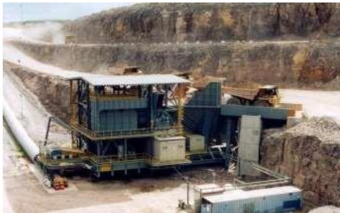
Figure I.11 : Concasseur à marteaux [2]
