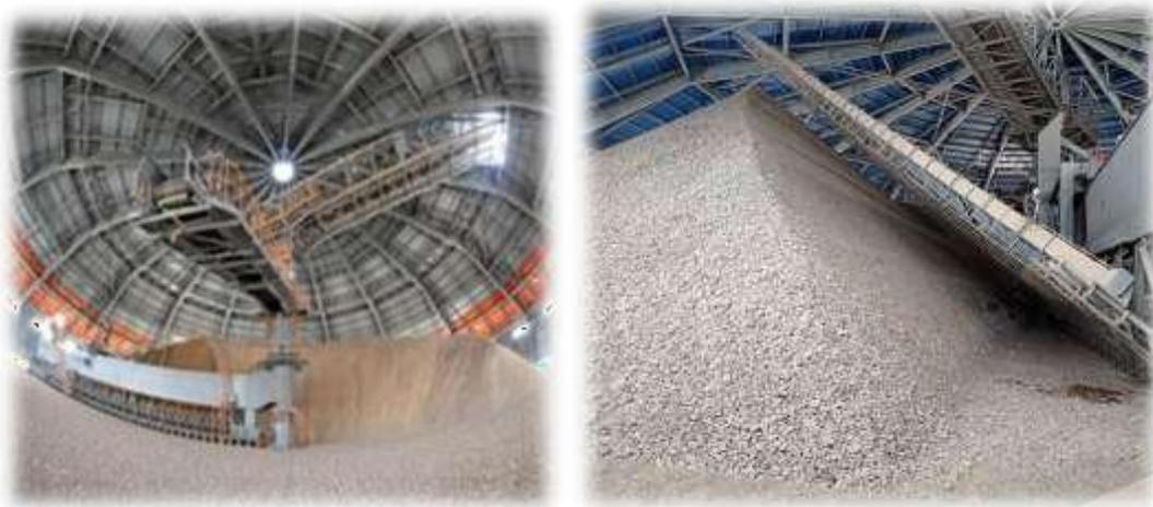
Figure I.12 : Hall Pré homogénéisation [2]
