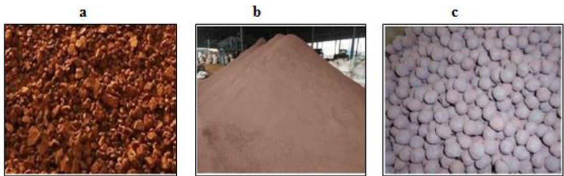
Figure V.1 Matières premières pour le haut fourneau : a) Minerai en morceaux, b) Fines de minerai, c) Pellets de minerai [24]
