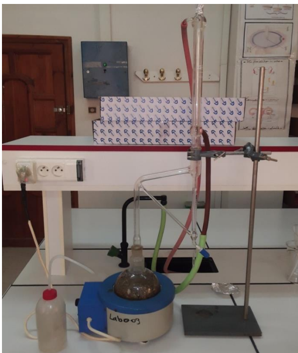
Figure 07. Montage de l'hydrodistillateur de type Clevenger ( Photo original )
