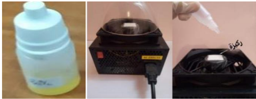
Figure II.4: Une photographie de la solution préparée par la voie sol-gel a été déposée sur les substrats en verre mis en rotation à l'aide du spin-coating
