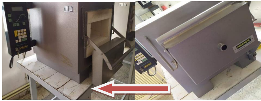
Figure II.6: Une photographie du four utilisé de traitement thermique Enfin, les couches minces ainsi fabriquées sont montrés dans la figure en-dessous (figure II.7)
