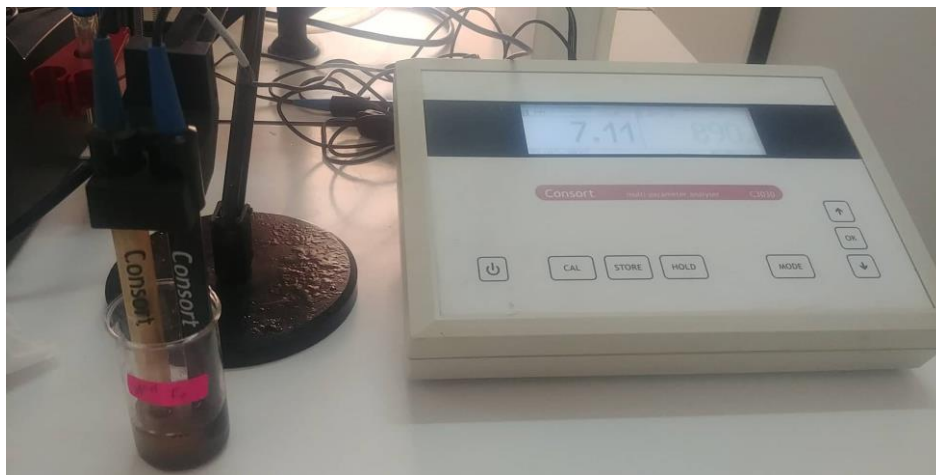
Figure 09 : La lecture du PH et la conductivité par PH-mètre
