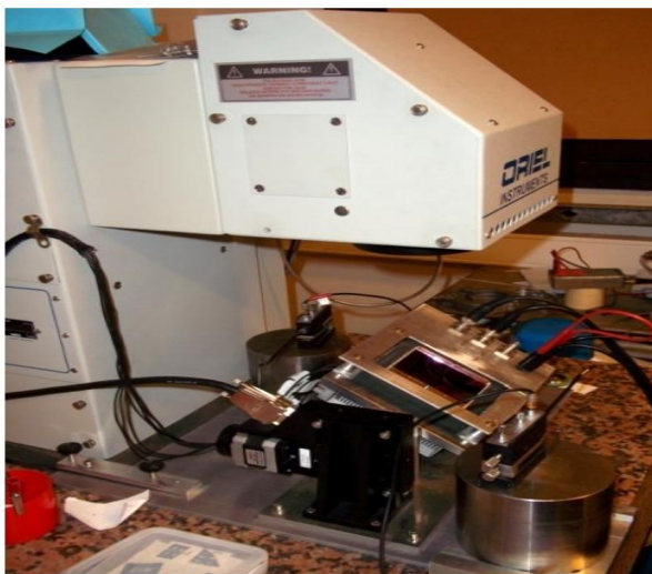
Figure I-4. Caractérisation en laboratoire a. simulateur solaire Lot-Oriel, de classe AAA du LGEP.
