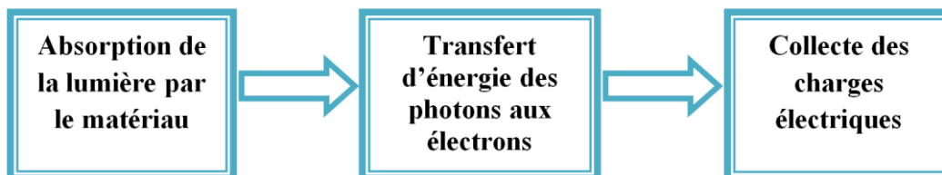
Figure I-1. Mécanismes de transformation de l'énergie solaire en une énergie électrique
