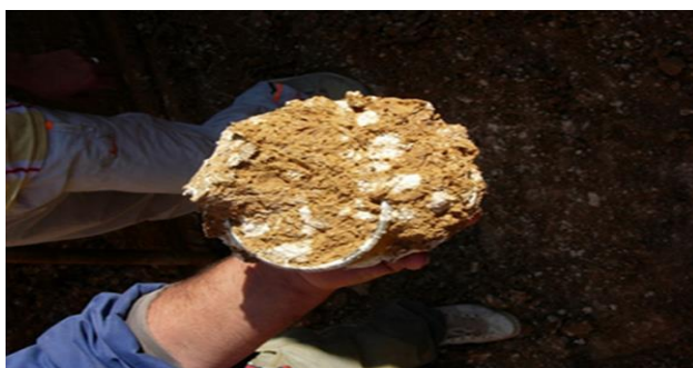
Photos N° 15 : Matériaux argileux, extrait de la zone d'emprunt, caractérisée la présence de carbonate ( CaCO_3 ) (Présentation du barrage d'ourkiss, 2011).
