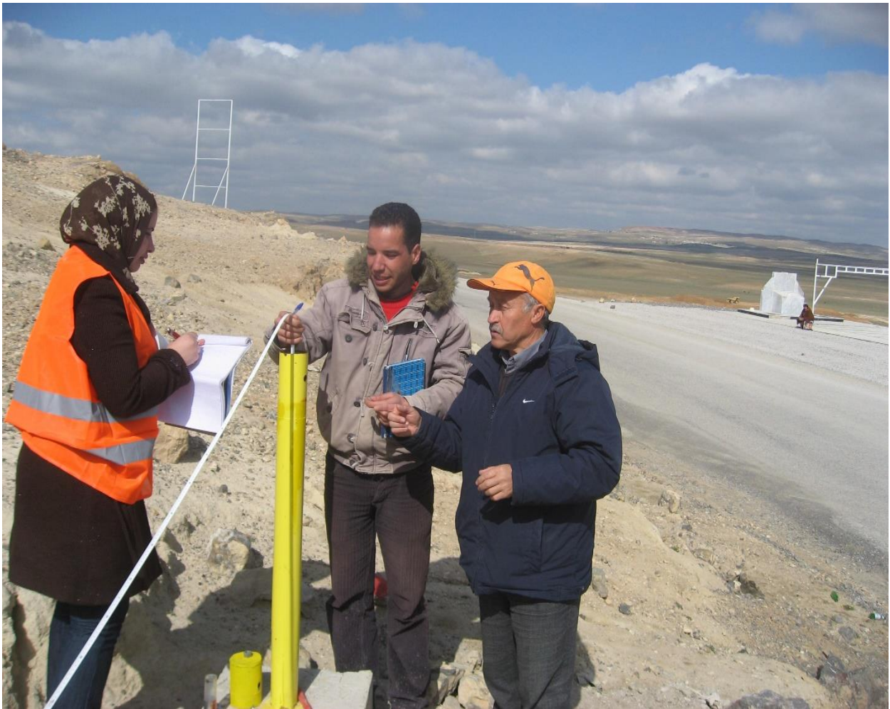
Photos N°24 : Lcture de niveau d'eau du piezomètre PR12, à l'aide d'une sonde hydroelectrique de mesure de niveau.
