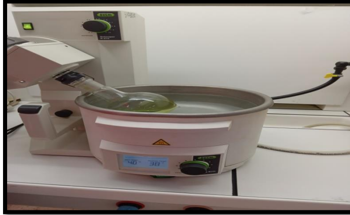
Figure 12. Evaporateur (Rota-vap) rotatif .(Photo personnel ,2022).
