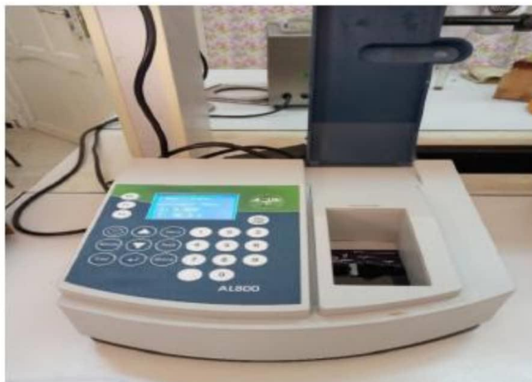
Figure 13: Spectrophotomètre UV à une longueur d'onde de 240 nm (Tedjani, 2022)
