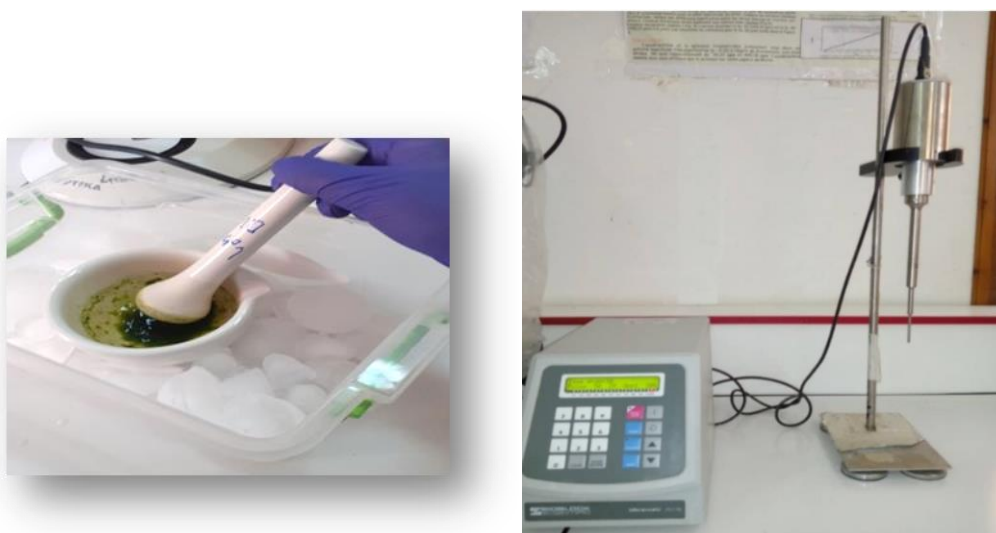
Figure 11: Broyage de feuille dans tampon et homogénéisateur du broyat pendant 30 sec (Tedjani, 2022)
