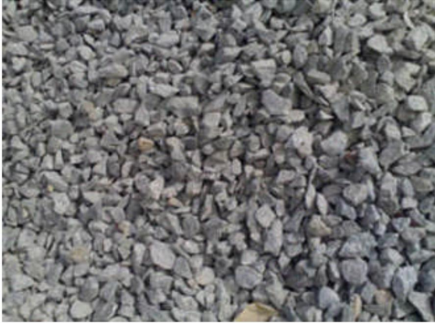
Fig.22 : Granulats pour béton
