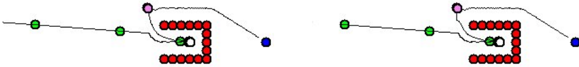
FIG. 5.8 – L'extraction du robot (en vert) par un attracteur (en violet). A gauche, un attracteur à charge simple, A droite, un attracteur à charge variable.
