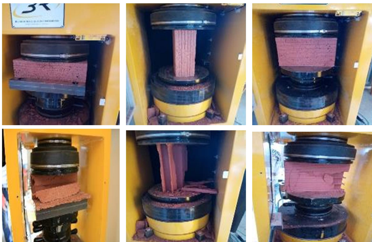
Fig. III. 2. 9 : Tests de compression sur les briques dans les trois directions.
