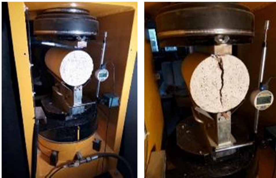
Fig. III. 2. 5 : Test de traction par fendage sur éprouvette du béton de 16x32.
