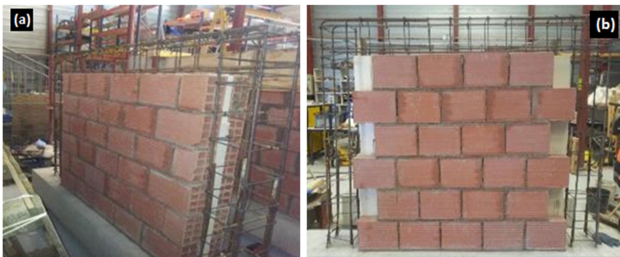
Fig. II. 2. 4 : Les deux types de spécimens avec chaînage uniforme (a) et chaînage harpé (b) (photo prise avant le coulage de béton).
