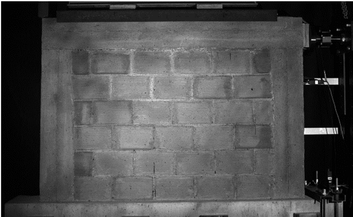
Fig. II. 4. 3 : Test sur le spécimen PC2 (chargement cyclique-panneau uniforme).
