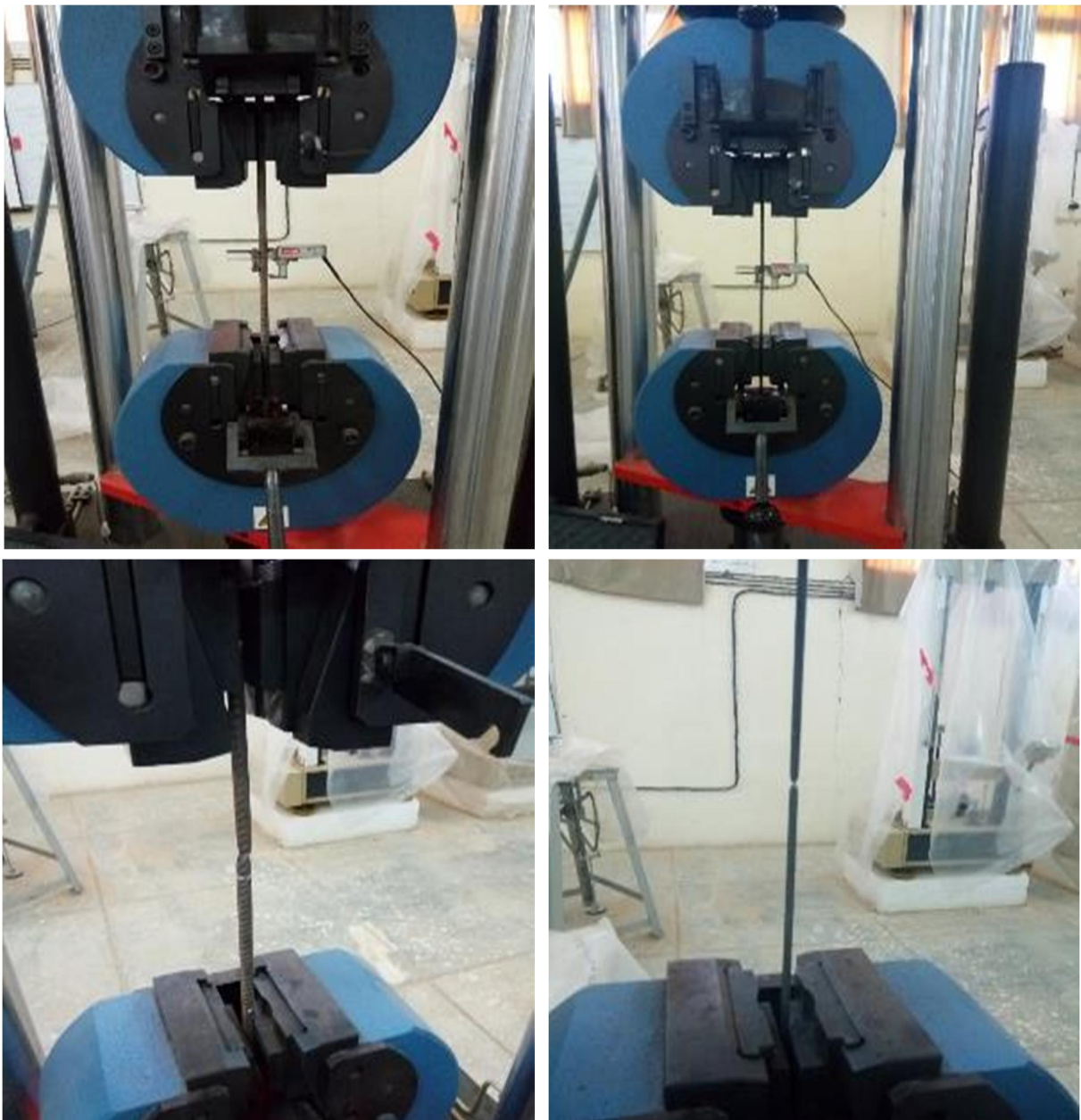
Fig. III. 2. 1 : Tests de traction sur les barres d'acier (éprouvettes avant et après rupture).
