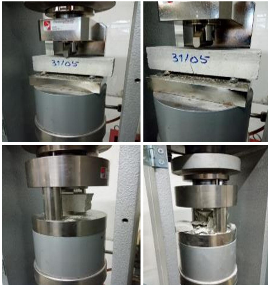
Fig. III. 2. 10 : Tests de flexion sur les prismes de mortier de 4 \times 4 \times 16 et de compression sur les tronçons de 4 \times 4 .
