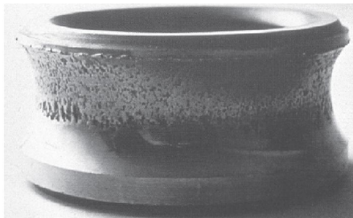
Figure IV.4 – Aspect de la bague interne d'un roulement surchargé
