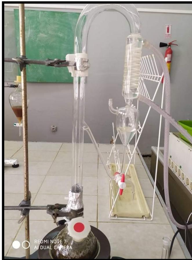
**Figure 12:** Montage d'extraction par Hydro distillation
