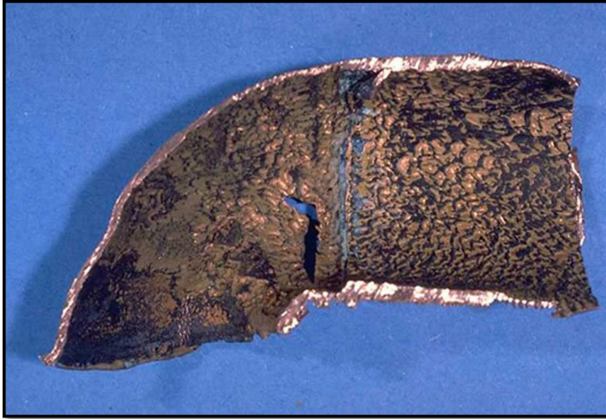
Figure- I.7 : Corrosion-érosion
