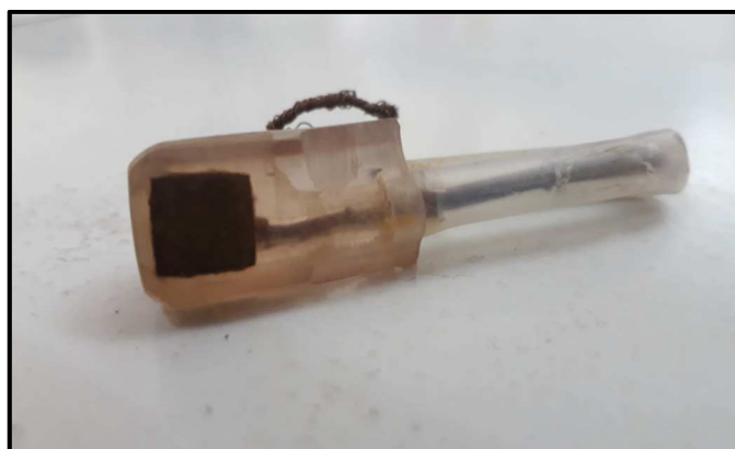
Figure II. 11 : Schéma d'une électrode de travail à l'acier API 5 L X60
