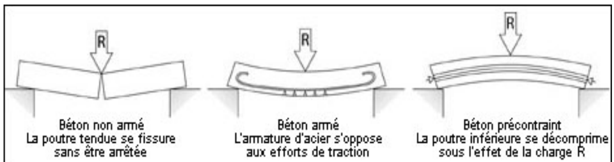
Fig. 78 : Principe du béton précontraint sur une poutre.
