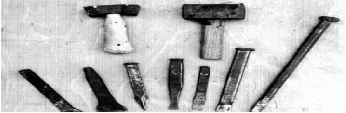
Figure 15: Les outils de construire romaine:2 massettes- Un ciseau dentelé (grain d'orge)- Une chasse- Un bédane- 3 ciseaux droits - une broche.source : www.enseigner-autrement.fr .
