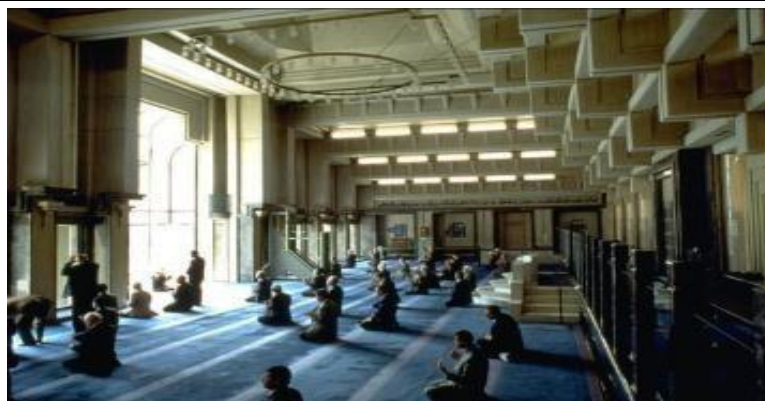
Figure. (2.41): Vue intérieure de la salle de prière principale montrant la lumière naturelle pénétrant à travers des ouvertures dans le toit pyramide à degrés. (Source: Archnet.org)
