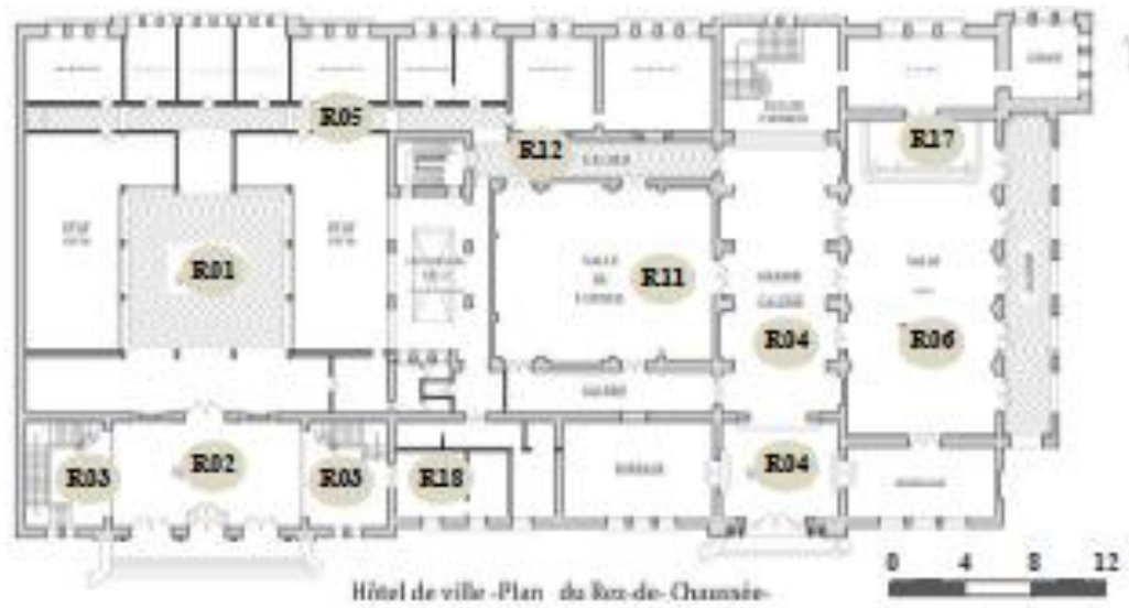
Figure .80 : Plan de repérage des revêtements de Sol du Rez-de-chaussée, hôtel de ville de Skikda . Source : Auteur
