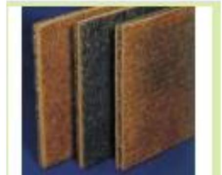
**Figure II.23:** la fibre de coco
