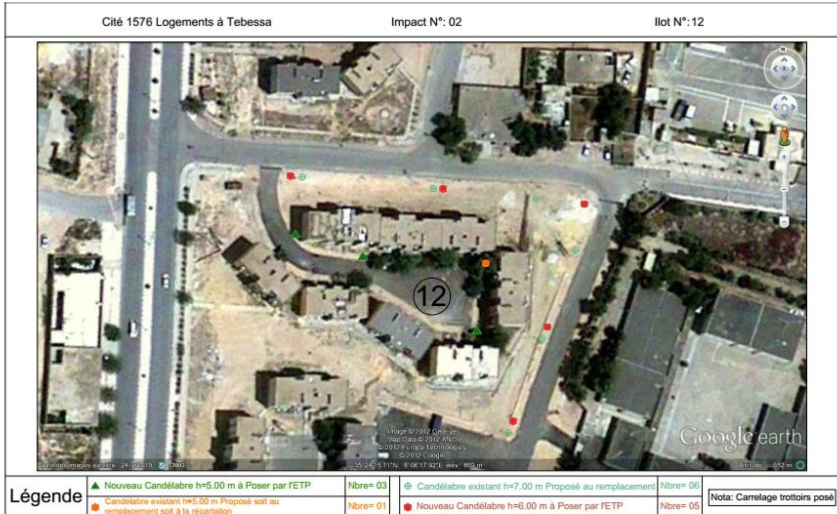
Fig. 26 : Plan de distribution des poteaux d'éclairage public.
