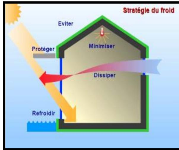
Figure n°05 : Les principes du confort d'été.
