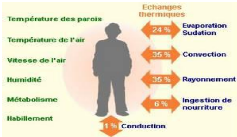
Fig 01 : les échanges thermiques du corps humain, Source : (énergie + 2019)
