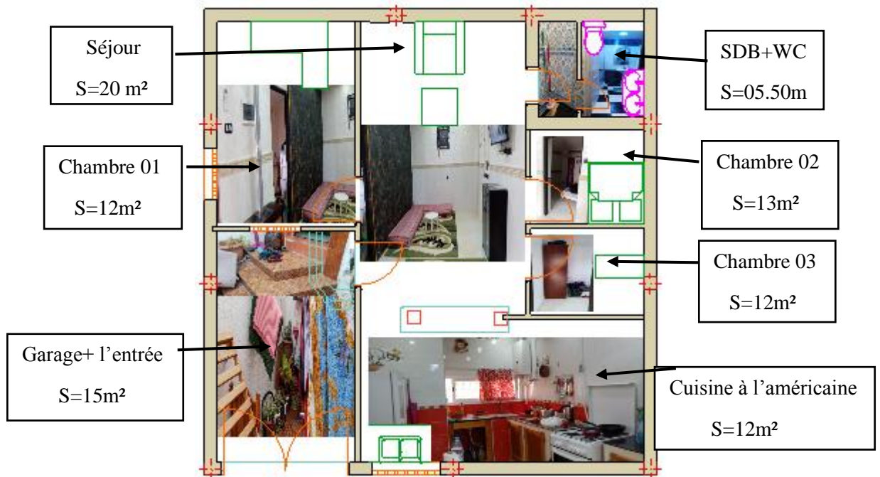
Figure n°158 : Plan intérieur d'un logement modifié.
