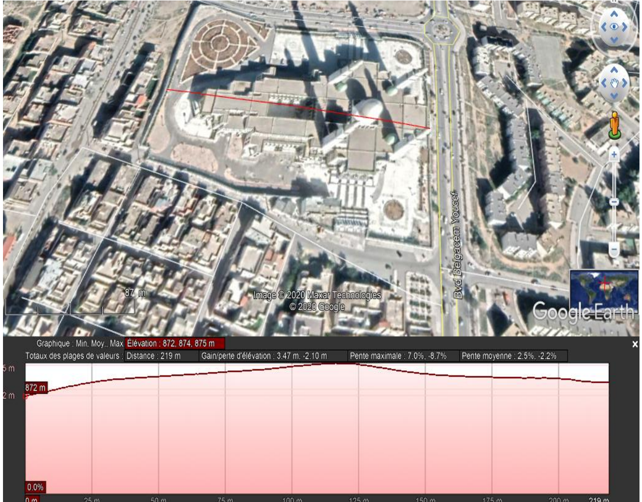
الشكل 3-6 مقطع طولي لأرضية المشروع
