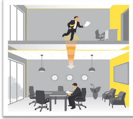
الشكل رقم 3: الضوضاء الناتجة عن الاصطدام بأرضية المبنى
