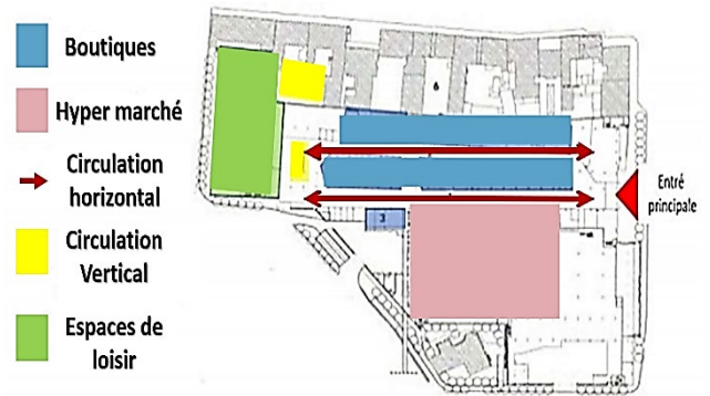
Figure 38: exemple d'une circulation horizontale de type linière
