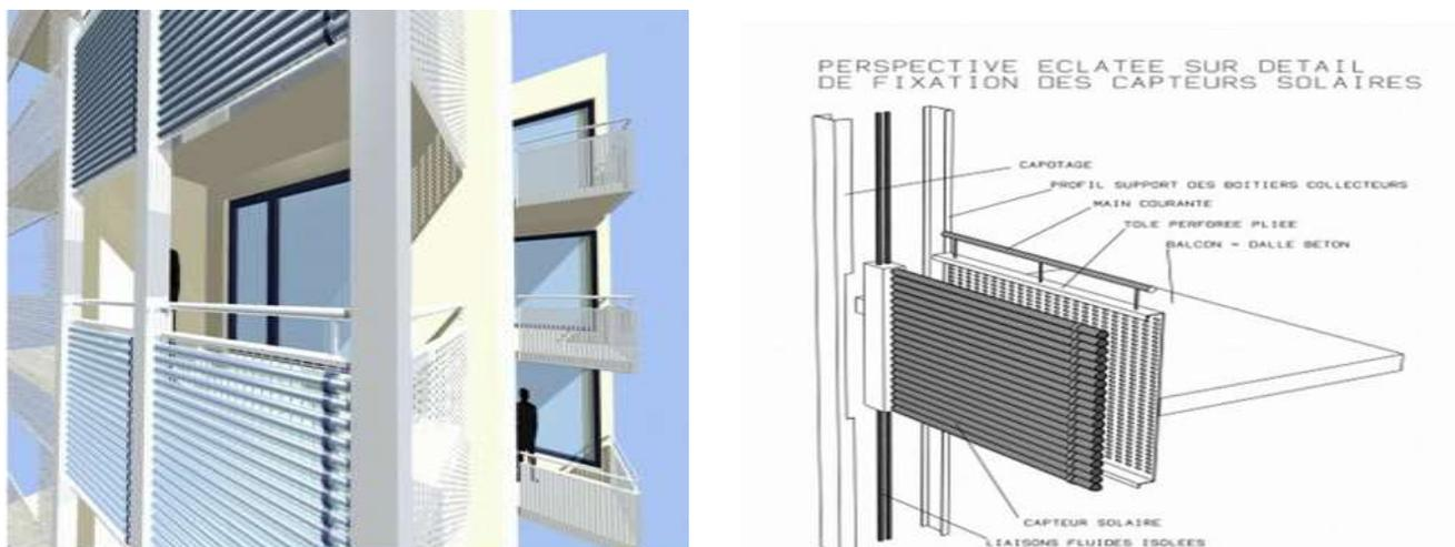
Fig3.12 garde corp avec des cellules photovoltaïque Source : (guid ENR 2021)
