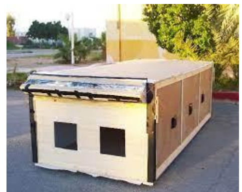
Figure 1- 4. Plafonds anidolique. Source : Daich et al, 2016
