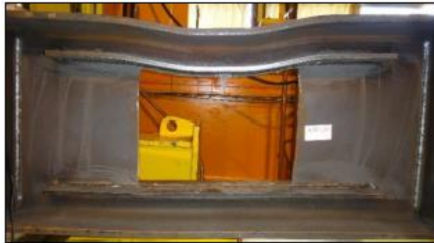
Figure 3.8 : Exemple de ruine par plastification de la membrure supérieure [1]
