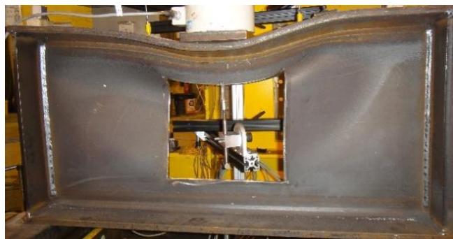
Figure 3.9 : Exemple de ruine par plastification de la membrure supérieure avec instabilité globale des du panneau d'âme avec ouverture [1]
