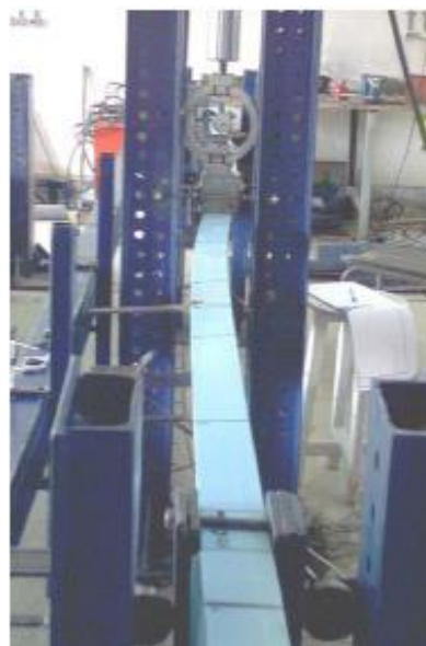
Figure 1.13 : Déversement d'une poutre cellulaire [19]
