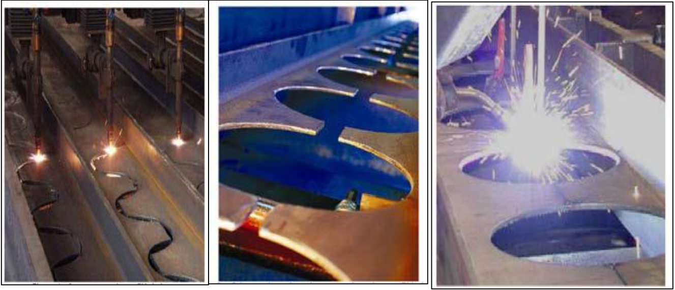
Figure 1.4 : Oxydation du profilé de base, séparation et soudage des deux parties [5]
