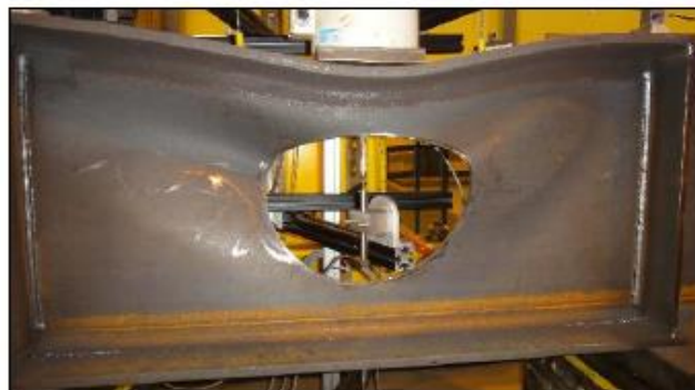
Figure 3.10 : Exemple de ruine par écrasement du panneau d'âme entre deux raidisseurs verticaux [1]
