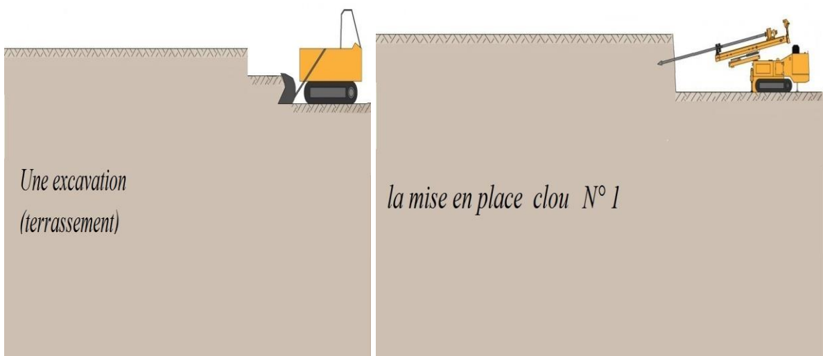
Figure 2.28 : mise en place d'un clou.
