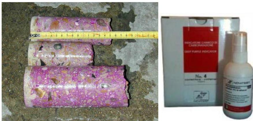
**Figure (II -3) :** Schéma de coloration du béton.
