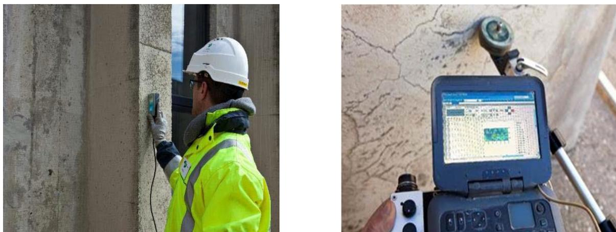
**Figure (II -2) : Mesure de la corrosion par potentiel d'électrode**
