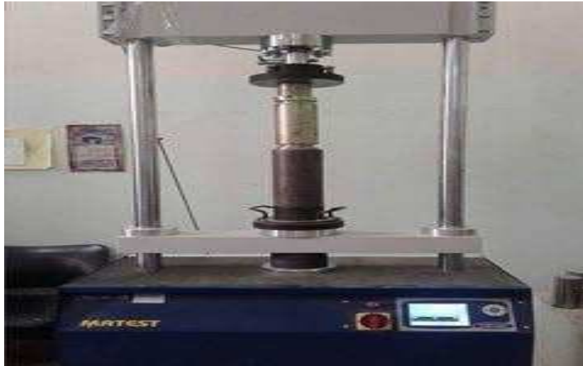
Photo V.8 : Opération de compactage
