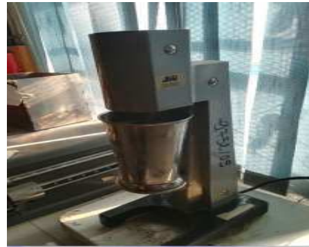
photo IV.12 : L'agitation du sable avec l'eau distillée
