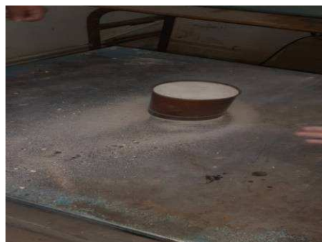
Photo IV.17 : Le coulage du sable dans le moule au-dessus de la table vibrante
