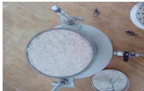
Photo IV.22 : La mise du sable dans le moule
