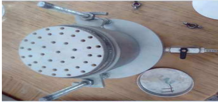
Photo I.23 : La mise du disque poreux sur le sable.
