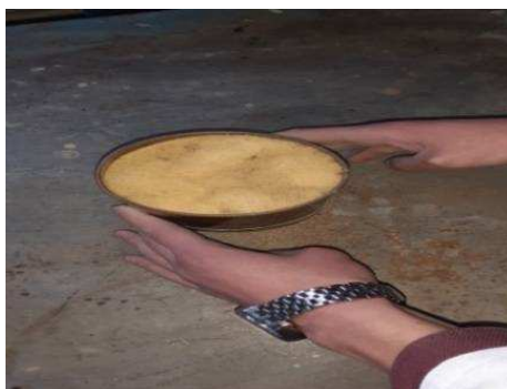
Photo IV.17 : Le coulage du sable dans le moule au-dessus de la table vibrante
