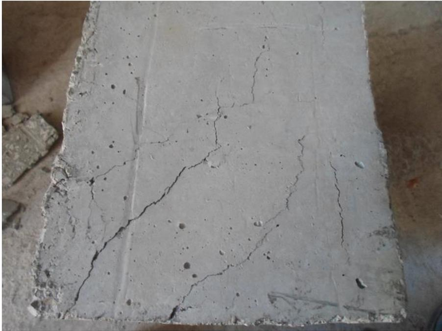
**Photo 4.4:fissuration et l'écrasement du béton**
