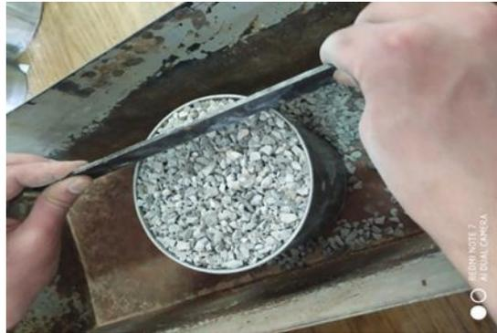
**Photo 3. 12: Essai de la masse volumique apparente**
