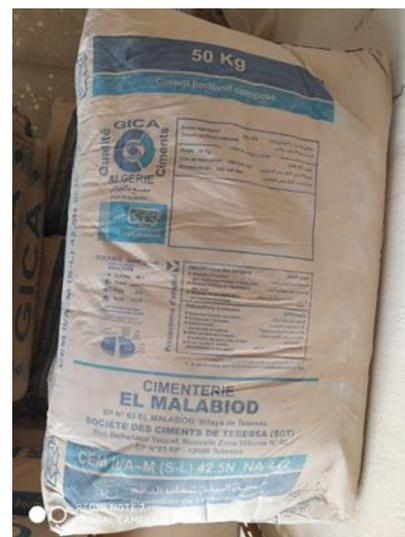
Photo 3.3: Le ciment CPJ-CEM II/A M (P-L) 42,5 l'usine GICA (ELMALABIOD)
