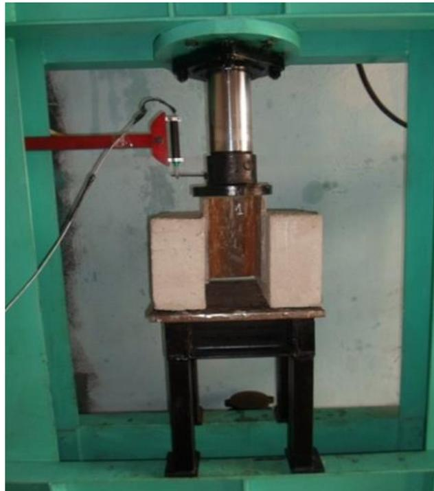
Photo 4.2: l'essai de poussé push-out
