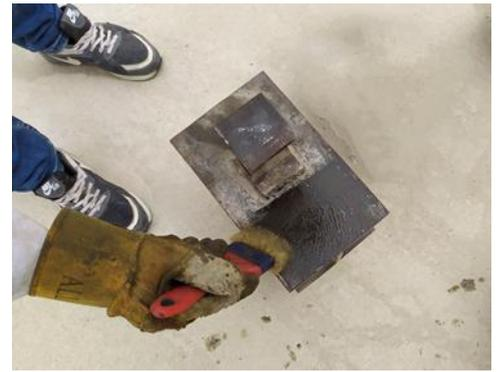
Photo 3.2 : Préparation des spécimens d'essai et Huilage des semelles
