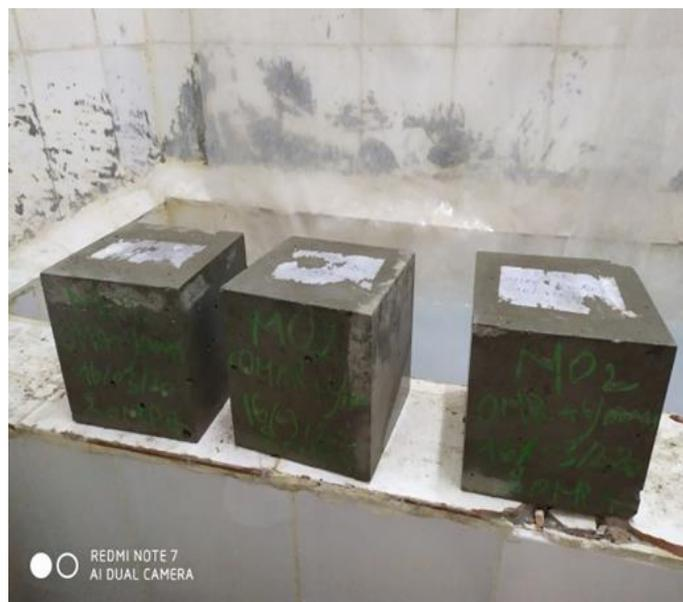
**Photo 3.17: Les éprouvettes cubiques normalisées**
