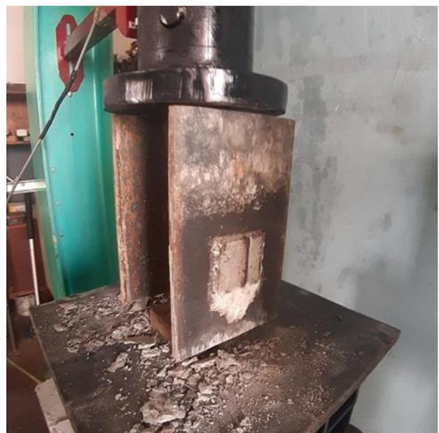
Photo 4.3 : Rupture par cisaillement du connecteur
