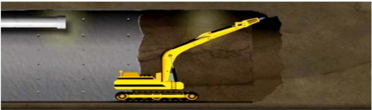
Figure I. 9. Détachement des blocs à l'aide de la brise roche [1].
