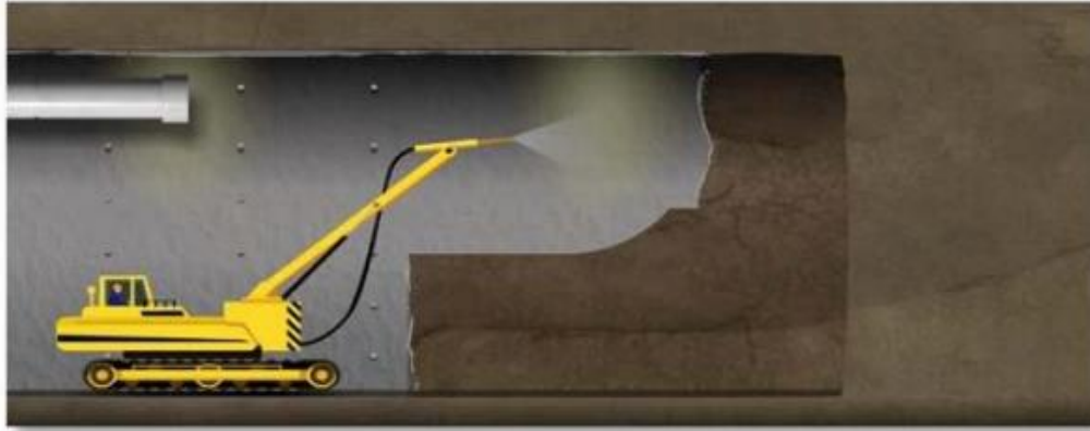
Figure I. 11. Application de béton projeté [1].
