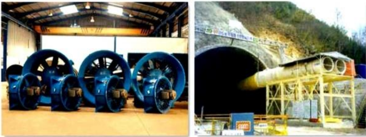
Figure I. 17. Ventilateurs / Ventilation du Tunnel
