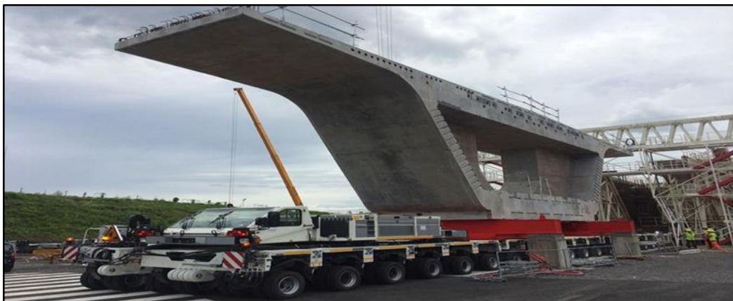
Figure 1.6. Fardier de transport des voussoirs
