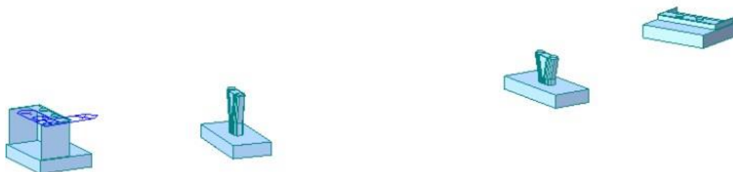
Figure 1.11. Réalisation des piles et culées
